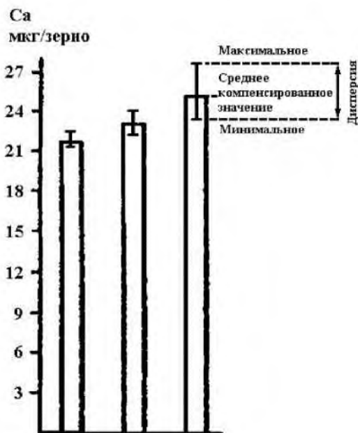
Рис. 3. Испытательные исследования. Содержания Ca, на зерно, в 3 сериях партий овса 'Нюприм', причем каждая серия анализировалась в разных лабораториях с помощью приборов разных типов - указана дисперсия в партиях для каждой серии.
