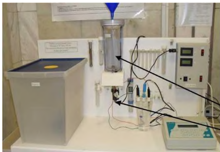
Рисунок 1 — Стенд для получения активированных водных растворов путем бесконтактной электроактивации «Изумруд СИ» (мод. 04 уч.) анолит католит
