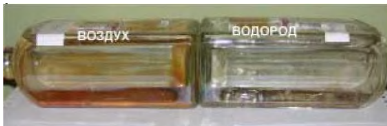
Рисунок 10. Наблюдение окисления металлического железа в воде. Слева - в газовой фазе воздух. Справа - в воду, первоначально содержащую растворенный кислород воздуха, вводился водород. Видно, что продукты окисления разные. Отсюда видно, что продукты, образующиеся в среде водорода и без него, существенно различаются. Это указывает на химическую активность молекулярного водорода в условиях эксперимента.
