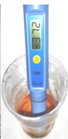
Рис. Измерения ppm (мг/л), ОВП (мВ) и ЭДС (мВ) на ДСИ-1, 2 - http://ikar.udm.ru
