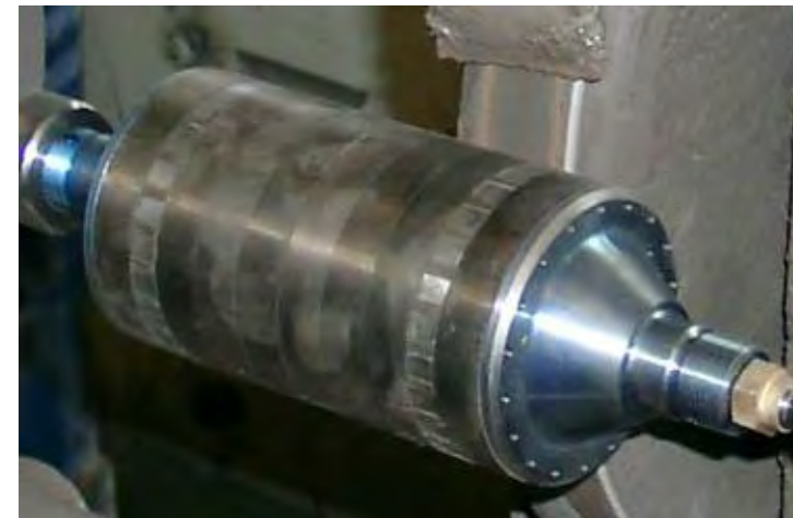
Обработка поверхности ролика на шлифовальном станке.
