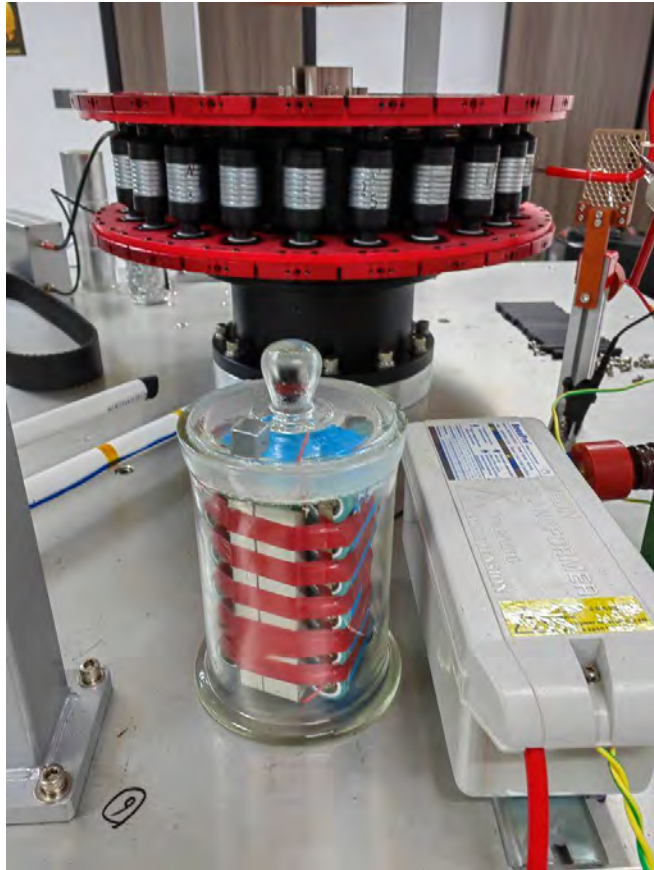
Герметичная банка с датчиком температуры и давления VME280 Bosch внутри
