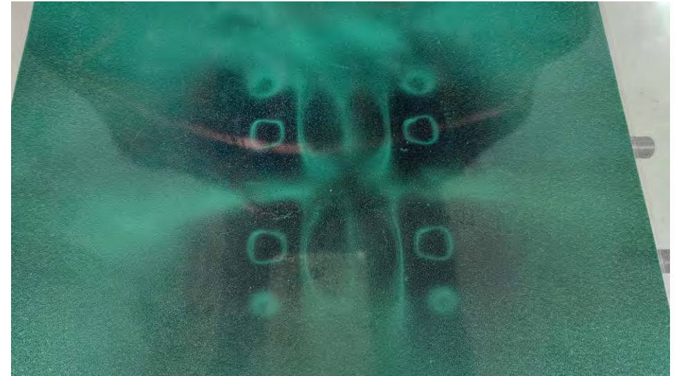
Структура магнитного поля роликов
