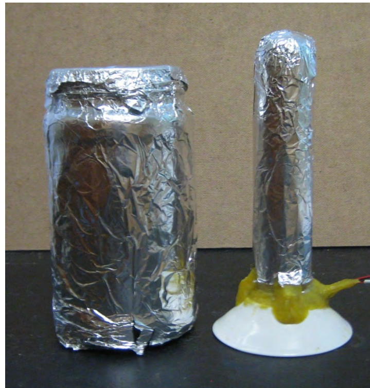
Герметичный сосуд и банка с лампой накаливания, погружённой в воду (LENR-реактор). Алюминиевая фольга защищает от яркого света.
