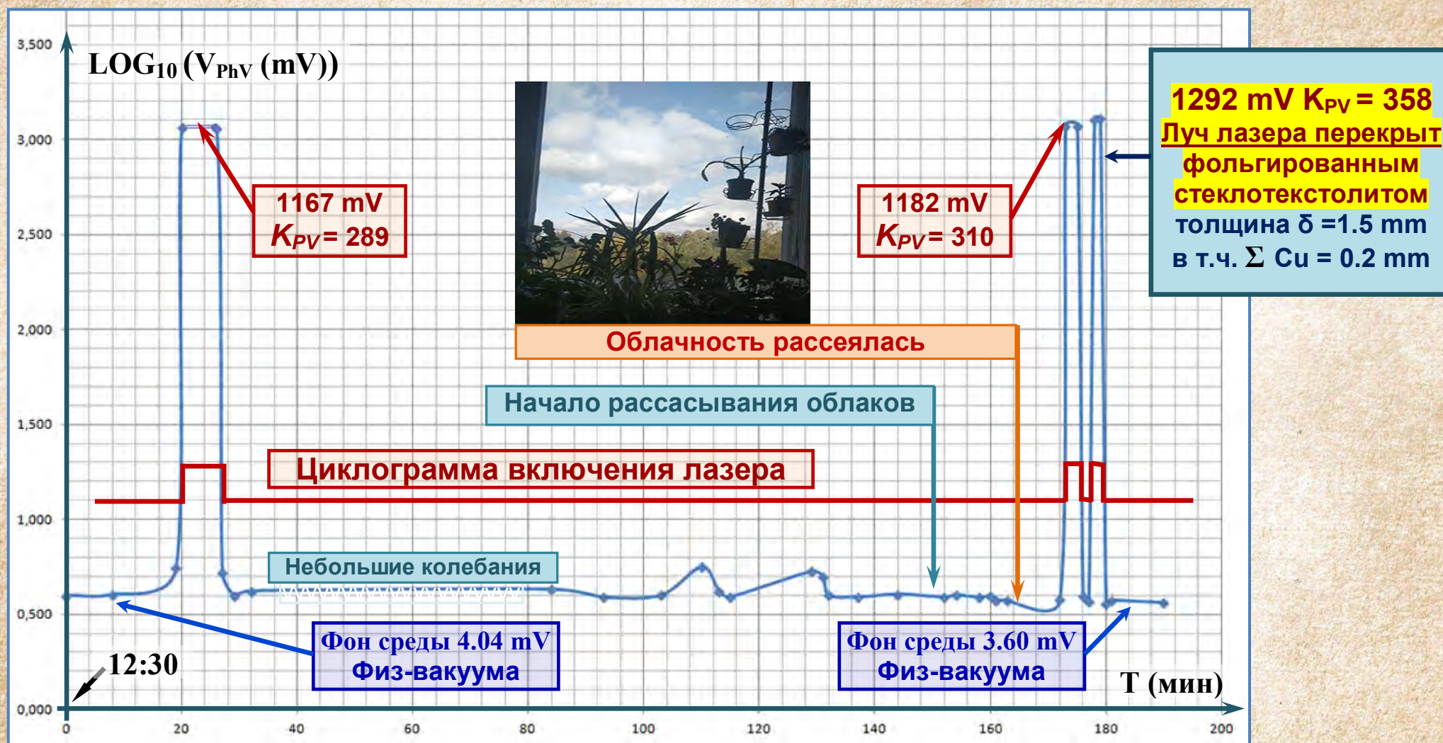
Рис. 4. График зависимости излучения He-Ne лазера от цикла включения и погодных условий среды.
