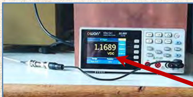
Рис. 3. Мультиметр XDM-1041 измерителя ИГЭД-2L с кабелем (показание при работе лазера = 1,1689 V ).
