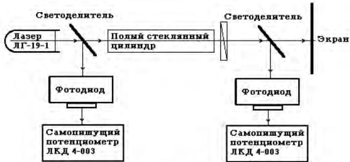
Рис.6.Схема установки с использованием He-Ne лазера.
