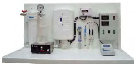
Учебно-методический стенд "Икар" ( мод.03ц ) для получения и исследования контактно активированных жидкостей.
