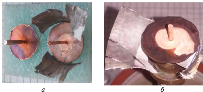
Рис.12. Примеры бумажных цилиндров после разряда, сопровождающегося взрывным разрушением анода.
