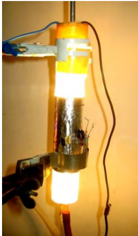
Рис. 2. Расположение полупроводниковых диодов около кварцевой трубки с лампой накаливания
