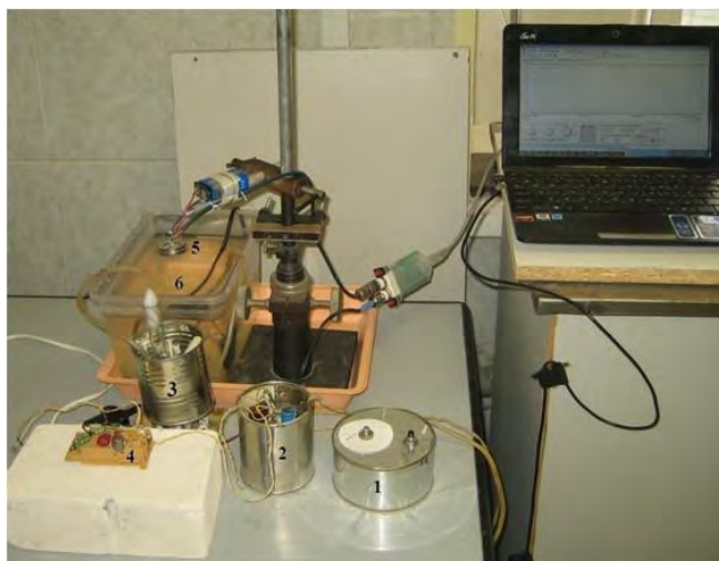
Рис. 5. Общий вид установки. 1 – реле времени (10 сек), 2 – источник питания, 3 – реактор (4 лампы по 150 Вт, проточная вода), 4 – усилитель сигнала датчика температуры, 5 – фотодиод, 6 - ванна с водой и помпой
