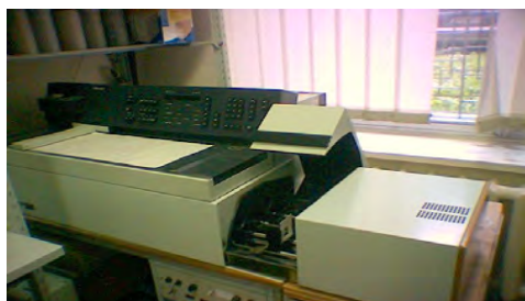
Спектрофотометры 2-х лучевые “Specord-M40, M80”
