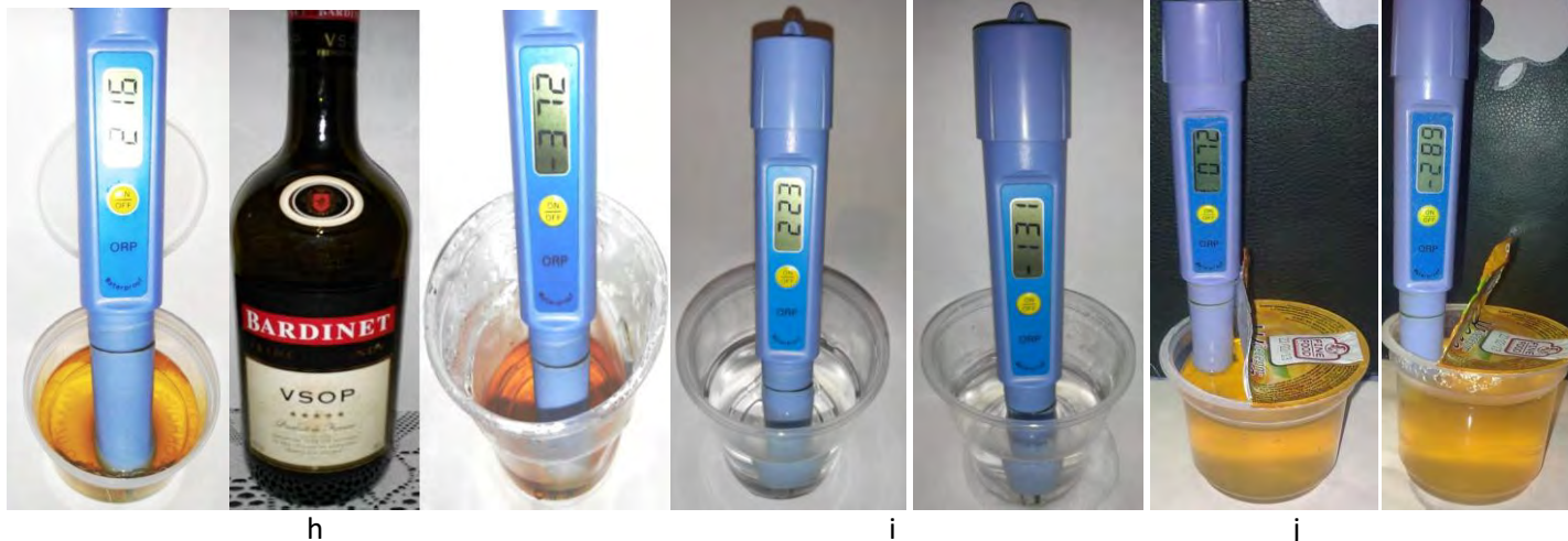
Рис. Измерения ррт (мг/л), ОВП (мВ) и ЭДС (мВ) на ДСИ-1, 2 - http://ikar.udm.ru
