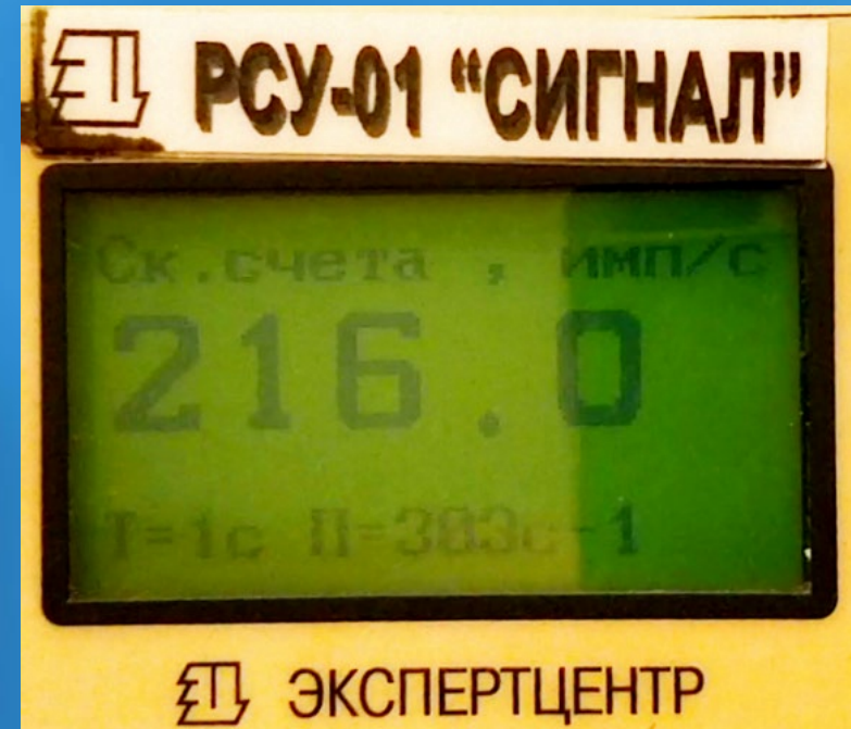
Display of РСУ-01 «Сигнал». Automatic X/\gamma -quanta counting with energies > 10 [keV].
