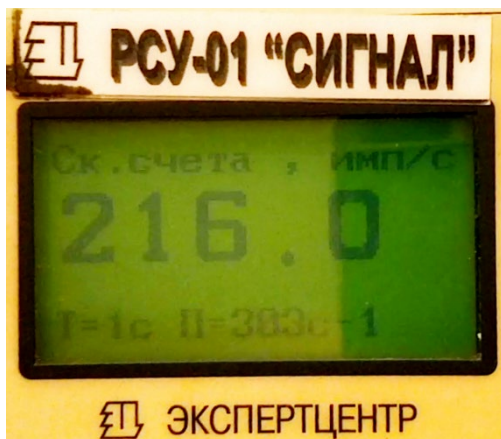
Рис. 11. Характерные данные РСУ-01 автоматического счёта интенсивности излучения в рентгеновском/ \gamma -диапазоне для энергий выше 10 [кэВ] на расстоянии 10 [см] от центра таблетки.
