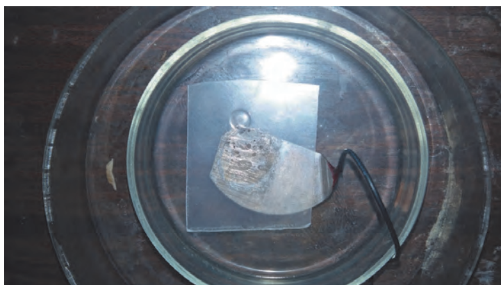
Рис. 34. Катод из никеля под диэлектрической пластинкой
