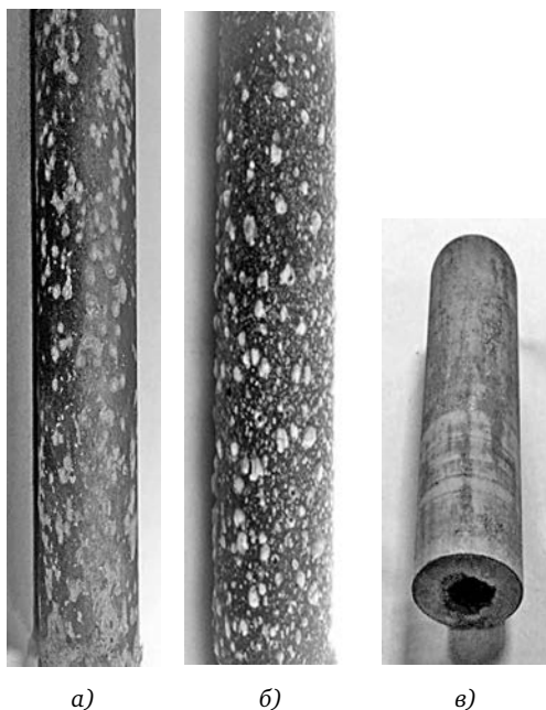
Рис. 5.21. Катоды после испытаний: а — термообработанный Д16Т; б — отожженный Д16Т; в — сплав 8% Cu + 92% Al
