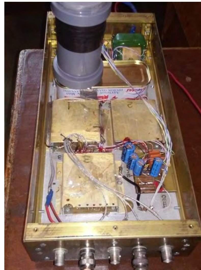
Блок детекторов альфа-распада и расположение П-излучателя Блок детекторов альфа-распада со снятой верхней крышкой
