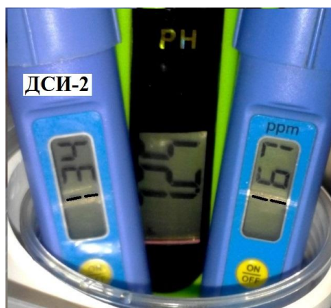
Измерения Э.Д.С., рН, ррт до рН-корректора по схеме Рис.1.
