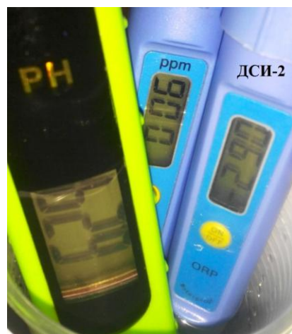
Измерения Э.Д.С., рН, ррт - после Реактора (100%) и рН-корректора (0%) по схеме Рис.2.
