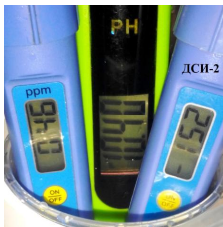
Измерения Э.Д.С., рН, ррт - после Реактора (0%) и рН-корректора (10%) по схеме Рис.2.
